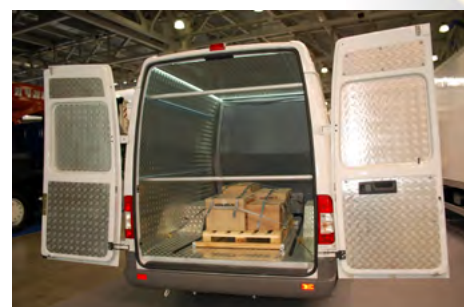
Грузовой отсек очень аккуратно отделан оцинковкой и крепежными приспособлениями
