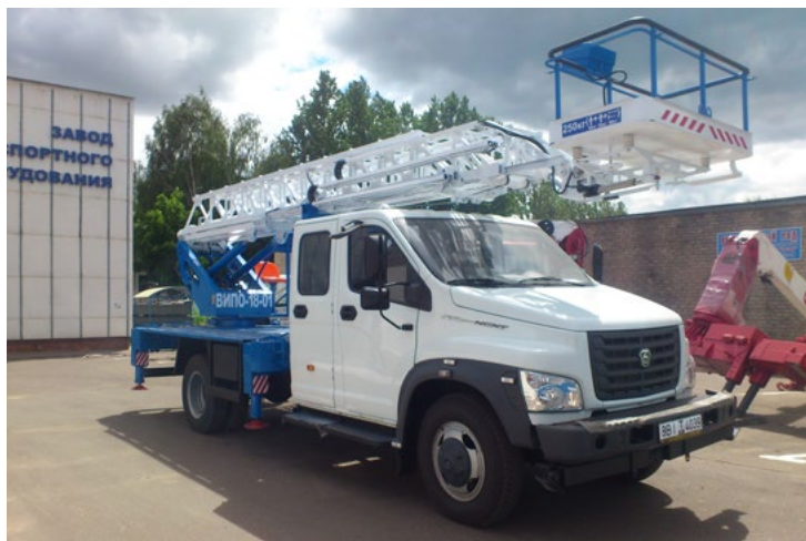
▲ Автогидроподъемники ВИПО-18-01-С42 и ВИПО-24-01-С42
