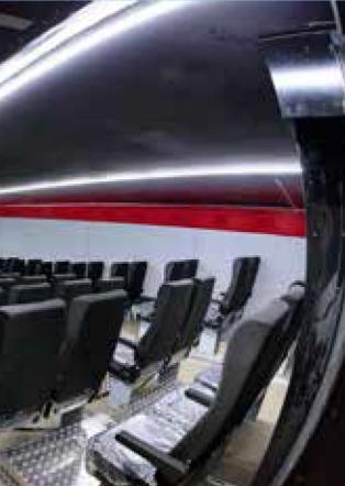
обзора пол имеет подъем от передней части к задней. В транспортном положении центральные кресла складываются, вместе с проходом поднимаются вверх и размещаются над боковыми. В зале установлен экран 4×1,6 м, ко-
