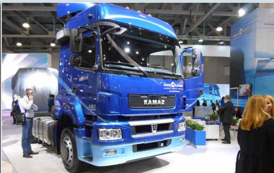
ны экономичные и «тихие» гипоидные мосты с передаточным отношением от 2,5 до 3,07. Грузовик оснащается одним топливным баком на 700 литров либо двумя – на 1200 литров.
