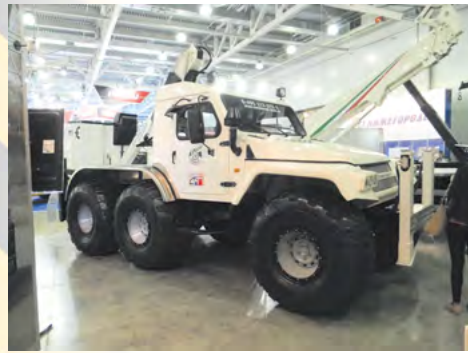
Уникальный плавающий гидродъемник Versalift, смонтированный компанией «Коминвест АКМТ» на шасси вездехода ТРЕКОЛ
