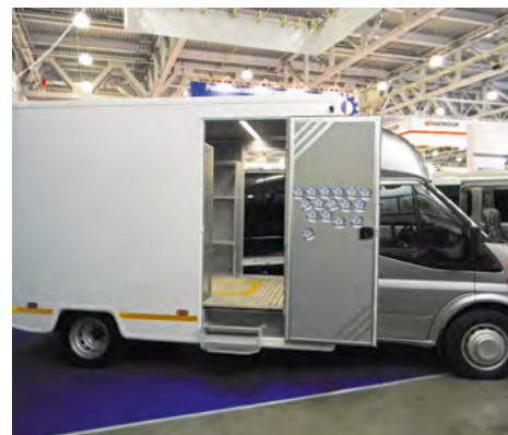
Каркасный фургон-мастерская на базе Ford Transit с оригинальной конструкцией механически откидывающейся подножки
