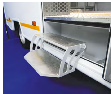
Каркасный фургон-мастерская на базе Ford Transit с оригинальной конструкцией механически откидывающейся подножки
