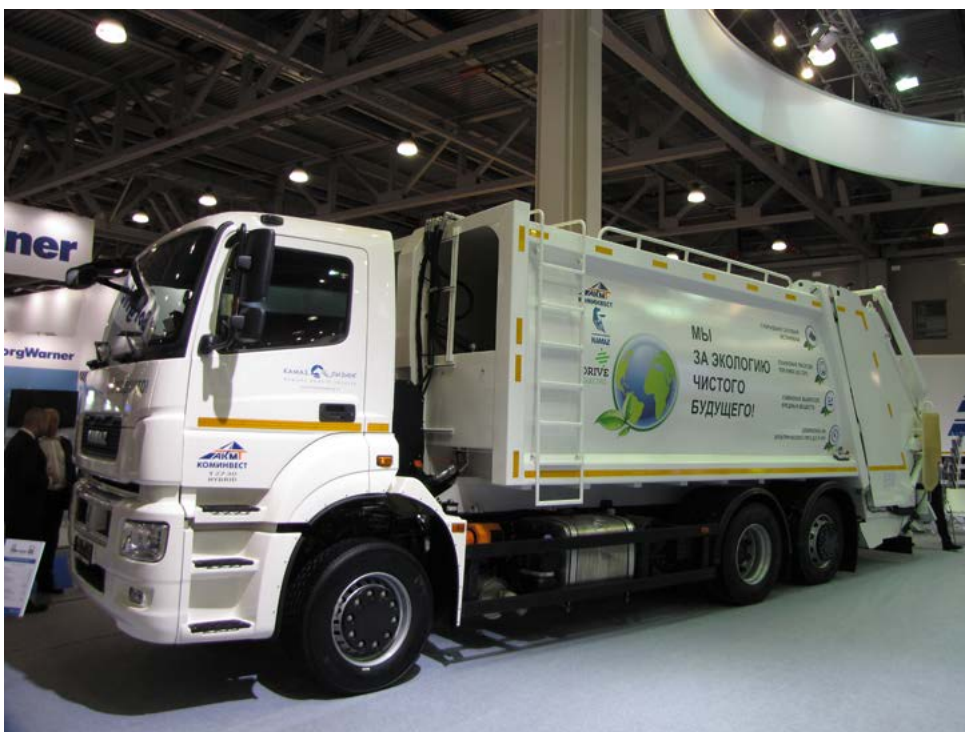
▲ Мусоровоз на шасси КАМАЗ-65208 с гибридной силовой установкой
