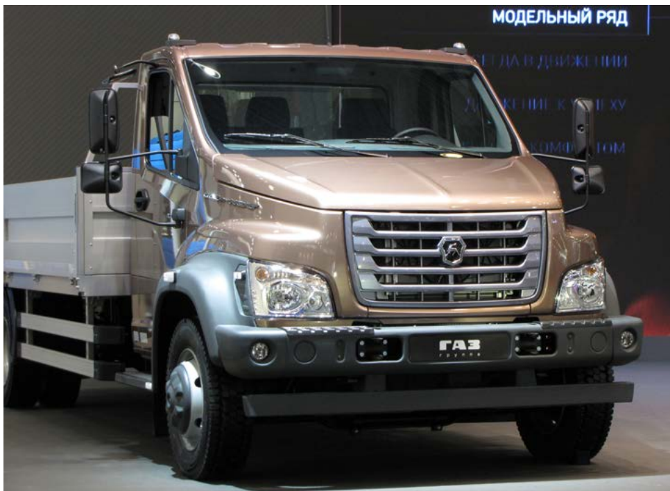
▲ «ГАЗон NEXT 8,7» грузоподъемностью 5,9 т выделяется широкими колесными арками, широким бампером и новым противоподкатным брусом
