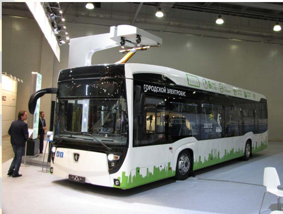
▲ Электробус КАМАЗ-6282 демонстрируется со станцией ультрабыстрой зарядки
