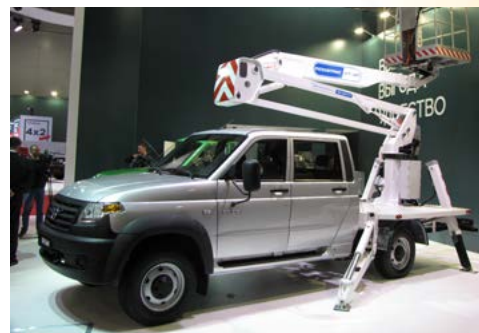
▲ Автогидроподъемник на шасси УАЗ «Профи» 4x4 с двухрядной кабиной
