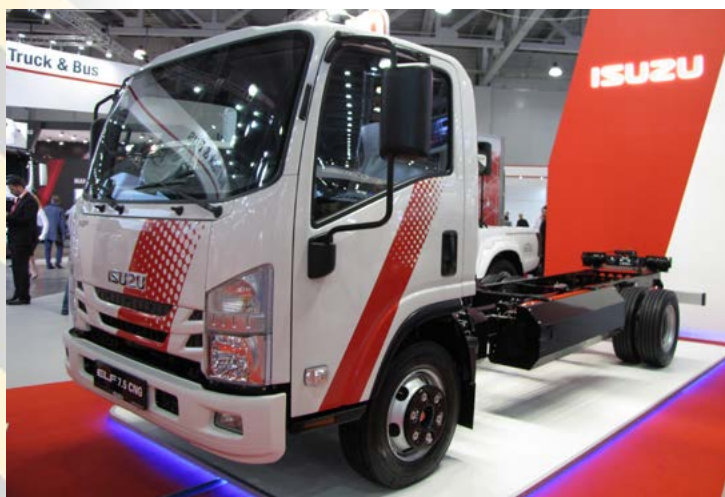
▲ Среднетоннажное шасси Isuzu NPR82/CNG с газовым двигателем
