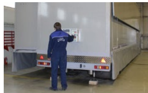
Механические опоры в заднем свесе полуприцепа улучшают устойчивость
