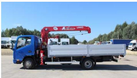
Бортовой JAC N75 с краном-манипулятором UNIC V370 г/п 3 тонны
