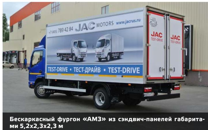
Бескаркасный фургон «АМЗ» из сэндвич-панелей габаритами 5,2х2,3х2,3 м
