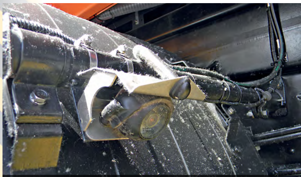
Грузовик по периметру снабжен камерами, выводящими изображения на центральный экран, установленный в кабине КАМАЗа
