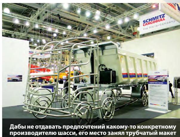
Самосвальный кузов объемом 20 м 3 от Schmitz Cargobull для любого 4-осного шасси
