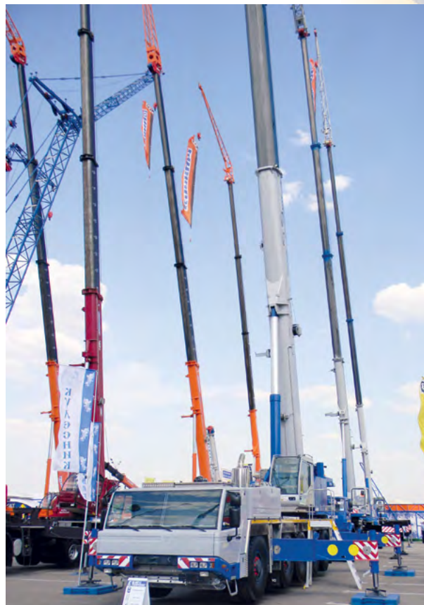
Первый российский 110-тонный кран КС-99713, созданный ГАЗ совместно с компаниями FAUN и Tadano
