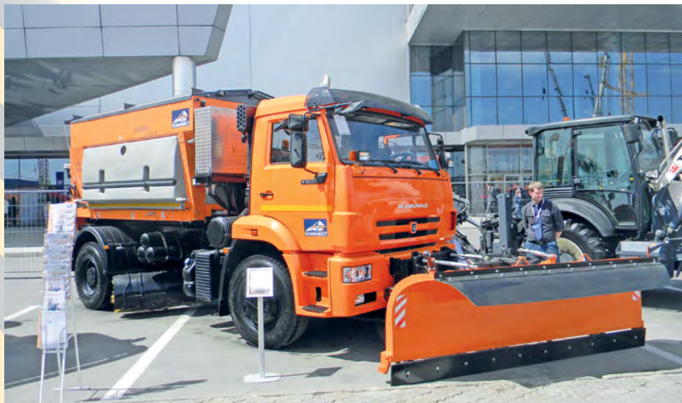
КДМ Epoke Sirius AST, смонтированная компанией «Коминвест-АКМТ» на шасси КАМАЗ-53605
