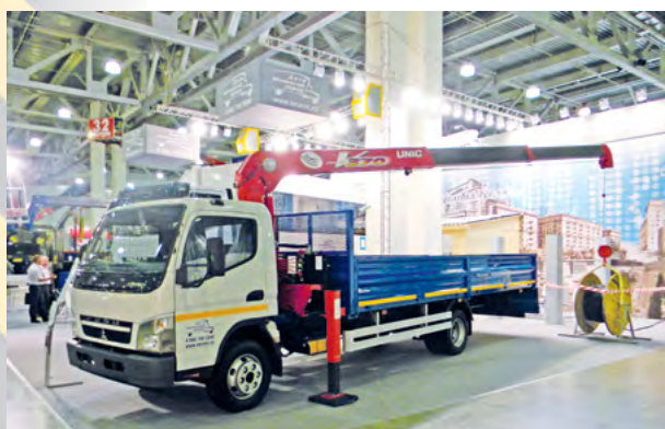
Бортовой автомобиль FUSO Canter с КМУ UNIC V370 с максимальной глубиной опускания груза 8,7 м
