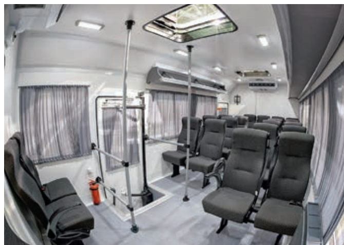
Система кондиционирования воздуха впечатляет – два огромных короба в противоположных концах салона
