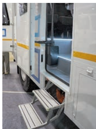
Особенность машины – служебная дверь прислонно-сдвижного типа и выдвигаемые ступеньки
