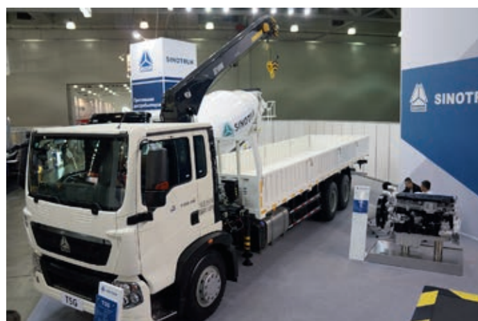
«Китаец» SINOTRUK T5G 28, представитель нового совместно с MAN семейства, да и кабина намекает. Справа виден новый мотор MC11 – тоже детище сотрудничества
