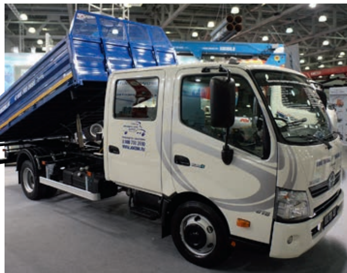
Модель 37630С создана на шасси Hino 300. Платформа на 5,3 куба опрокидывается на 35° назад и на 45° – в сторону и позволяет перевозить 4-метровые неделимые грузы
