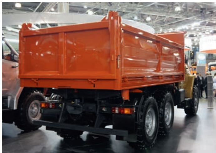
Самосвал «Урал NEXT 5557-6121-74» оснащён 11-кубовой платформой с трёхсторонней разгрузкой. Интересно, что задний борт кроме «автозамков» имеет ещё и страховочные «шпингалеты»
