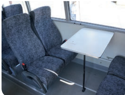
НефАЗ-42111М на шасси КАМАЗ-435024. Все 20 кресел оснащены трёхточечными ремнями, но окна разномастные, потому направляющие шторок не совпадают со стойками
