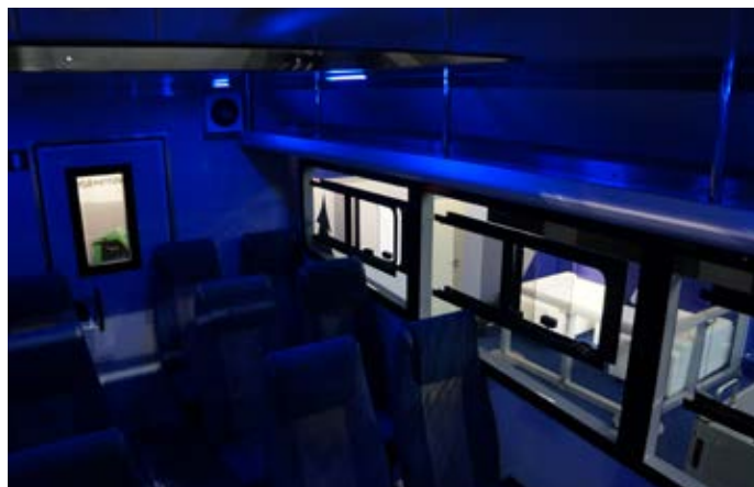
Надстройка похожа по конструкции с демонстрировавшейся на Comtrans'13 «вахтовкой» на шасси КАМАЗ-431184. С поправкой на размеры нынешний автобус рассчитан на 15 пассажиров в салоне (три «перевертыша») и 2 в кабине. В остальном те же особенности: двойные окна, багажные полки, оригинальный дизайн
