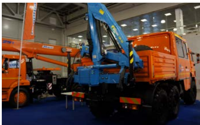
Многофункциональный автомобиль экспонировало на стенде КАМАЗ предприятие «КРАН центр КАМАЗ». Модель 6586N3-0000304-30 на полноприводном шасси КАМАЗ-5350, кроме 6-местного пассажирского модуля и грузовой платформы с правым откидным бортом, оснащена КМУ Инман ИН-50 в кормовом свесе
