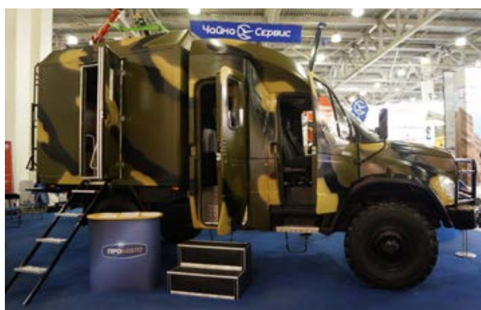
Отдельного упоминания заслуживает модель 278441 Тайга-VIP от «Чайки-Сервис». Гибриды на шасси «Садко» с 7-местным модулем из элементов металлической кабины «ГАЗели-Бизнес» и оригинальной пристройки с пластиковыми панелями выпускаются поштучно, но пользуются спросом
