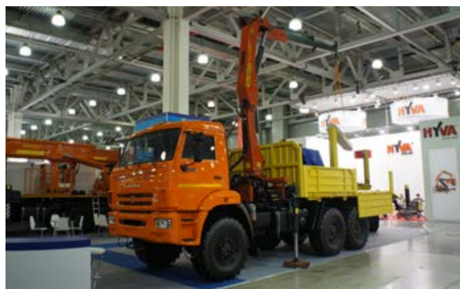
«Пермский завод грузовой техники» представил автопоезд-опоровоз в составе тягача модели 5908ВН на шасси КАМАЗ-43118 и телескопического прицепа-ропуска мод. 90731В. Тягач оснащён КМУ Palfinger, а благодаря поворотному конику и съёмным бортам легко может превращаться в обычный грузовик
