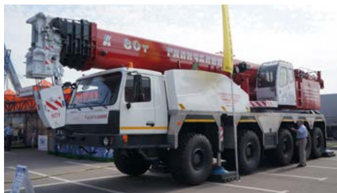
Возможности же отечественного шассистроения можно было увидеть на примере модели КС-74713. На полноприводном шасси МЗКТ 790200 смонтирован 80-тонник с колёсной формулой 10x10 и по сути является полноценным вседорожником. Прицел на нефте- и газодобывающую отрасль?
