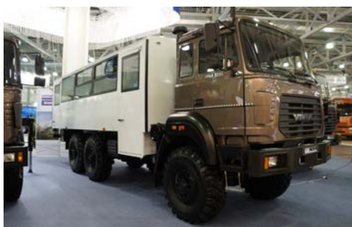
Вахтовый автобус «Урал-3255-3013-79» на трёхосном полноприводном шасси «Урал-М». Кроме рестайлинга внешнего вида и интерьера кабины комплексная модернизация коснулась и конструкции автомобиля в целом. Планируется, что «Урал-М» встанет на конвейер со второй половины 2014 года
