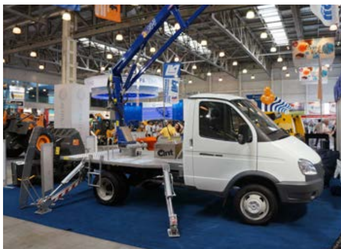
Самый неожиданный производитель выставки – «Ковровский автомеханический завод». Предприятие занимается монтажом подъёмников АНТ 14-7 на различные шасси грузоподъёмностью от 1100 кг, как отечественные, так и импортные. В этот раз на стенде красовалась автовышка на базе ГАЗ-3302 «ГАЗель»
