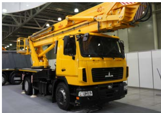
«Минский автомобильный завод», а точнее его филиал «Могилёвтрансмаш», продемонстрировал автогидроподъёмник АГП-40-8 на популярном нынче у «высотников» шасси МАЗ-5340В2. Максимальная высота подъёма составляет 40 м, а грузоподъёмность металлической рабочей платформы – до 350 кг
