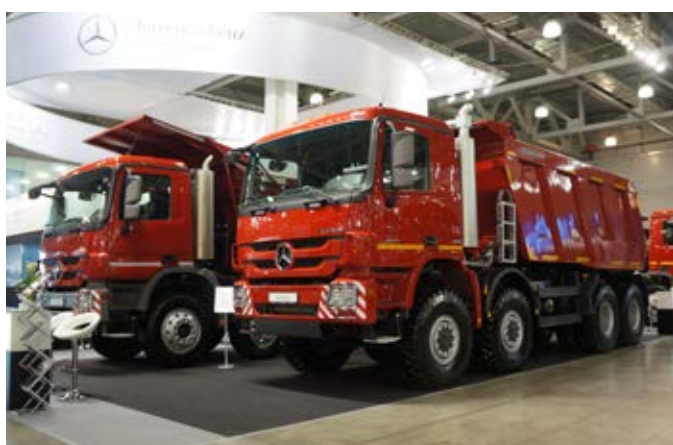
Стенд Mercedes-Benz украшали сразу два 20-кубовых самосвала: полноприводный с блокировками всех дифференциалов СИАЗ 9596-02-50 с платформой Meiller-Kirger на шасси MB Actros 4144AK 8x8 и его аналог для перевозки скальных пород на шасси на MB Actros 4141K 8x4 от компании «ИнтерПайпВан»
