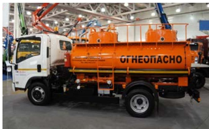
НПП «Автомаш» представило и компактный топливозаправщик АТЗ 4.9 на шасси Isuzu NPR75 вместимостью 4900 л. По функционалу машина ничем не уступает «большому» собрату, но более маневренная за счёт меньшей длины и ширины, что удобнее при работе на тесных городских АЗС
