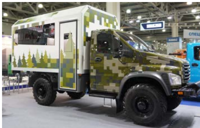
«Вахтовка» на базе ГАЗ Садко Next С41А23 от ПСП-НН. Нюансы шасси: дополнительная поперечина в задней части рамы, усиленное основание платформы, шины КИ-115А с увеличенной несущей способностью, удлинённые рессоры впереди, интегральный рулевой механизм ZF, электропривод «краздатки»
