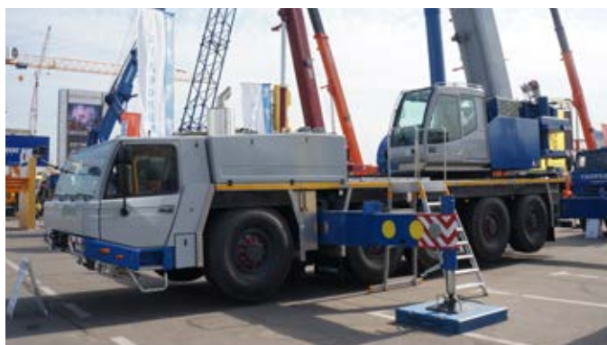
Галицкий автокрановый завод привёз на выставку первый отечественный автокран грузоподъёмностью 110 000 кг. Ввиду отсутствия в нашем автопроме шасси, отвечающего всем требованиям к подобной технике, модель КС-99713 базируется на специальном шасси Tadano-FAUN с колёсной формулой 10x8
