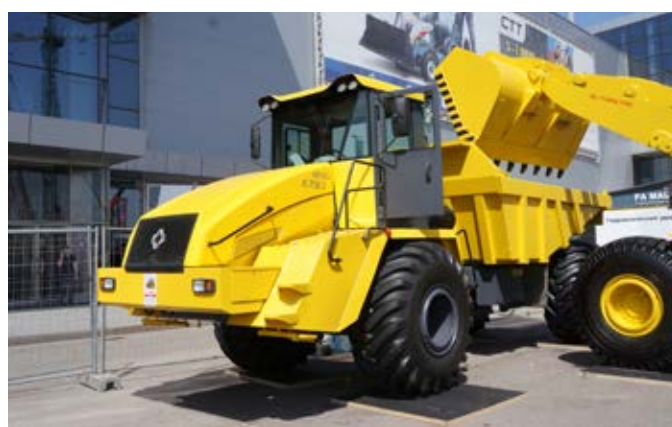
«Петербургский тракторный завод» в этом году порадовал не просто новой моделью, а новым направлением. Шарнирно-сочленённый самосвал К-708.2 «Кировец» создан на базе тракторного модуля К-708, премьерный показ которого состоялся в прошлом году. Машина рассчитана на перевозку 20 000 кг породы
