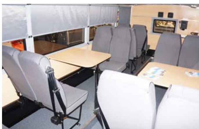
«Урал» пошёл своим путём и пассажирскую часть сконструировал самостоятельно. Вышло довольно оригинально: в салоне 22 кресла с 2- и 3-точечными ремнями, в центре два «переговорных» места с массивными столами. Хотя все сиденья устанавлены на подиумах, «печки» почему-то смонтированы под креслами
