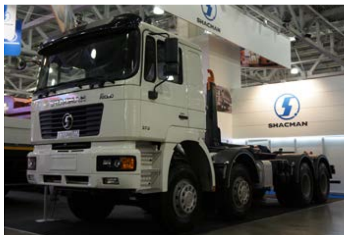
Продукция КБ «Спецавтотехника» заполнила практически весь стенд Shacman. И крюковой погрузчик модели JRDT61 на шасси Shacman SX3316 с колёсной формулой 8x4 и старой кабиной серии F2000 занимал в экспозиции достойное место. На данном этапе автомобиль выпускают на основании СБКТС
