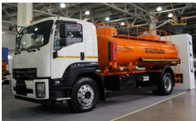
Топливозаправщик АТЗ 10 на шасси не так уж давно вышедшего на российский рынок Isuzu FVR34 представила компания НПП «Автомаш». Стальную цистерну эллиптического сечения вместимостью 10 000 л можно заполнять через верхние или нижние горловины с помощью собственного или внешнего насоса
