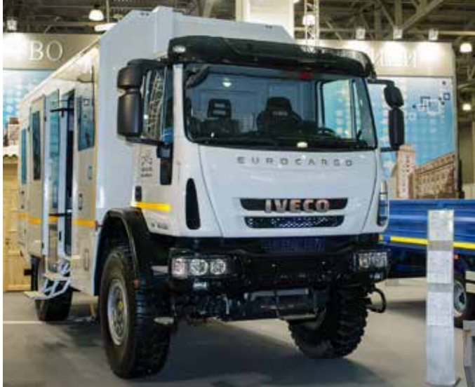
Вахтовый автобус «Автомеханического завода» на шасси Iveco-AMT Eurocargo 423900 4x4.
