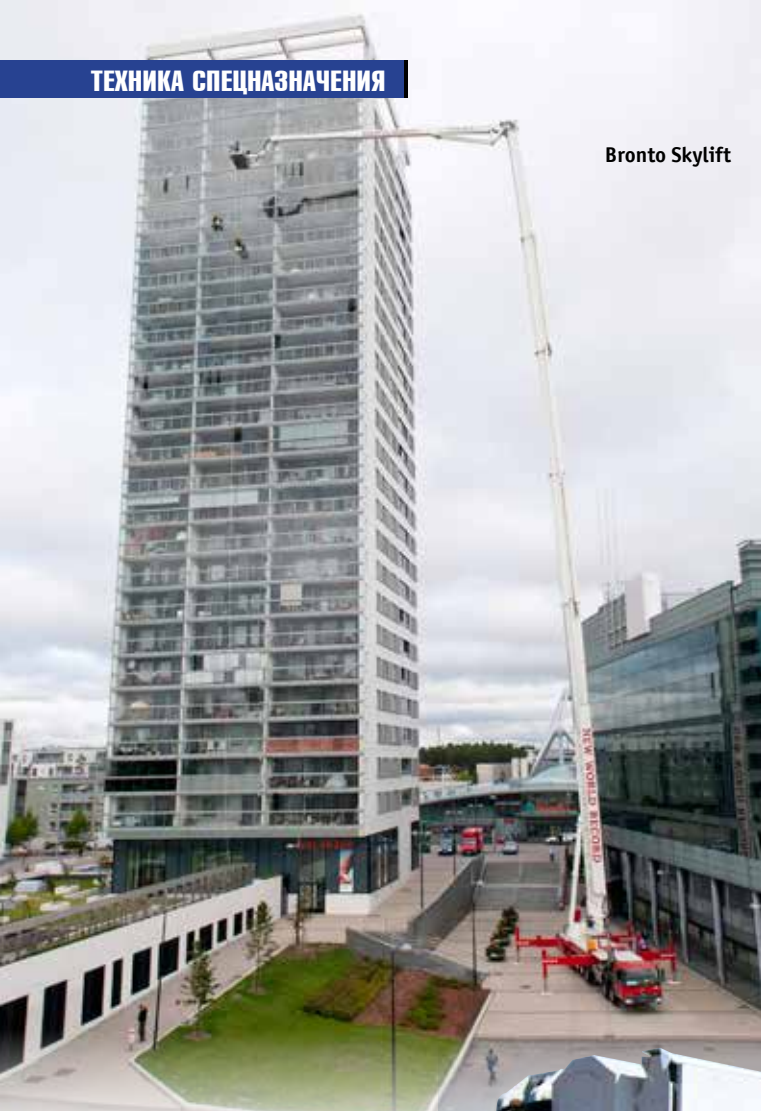
Самый высокий коленчатый подъемник российского производства АКП-50 на базе КАМАЗ-6540 выпускает АО «Пожтехника»
