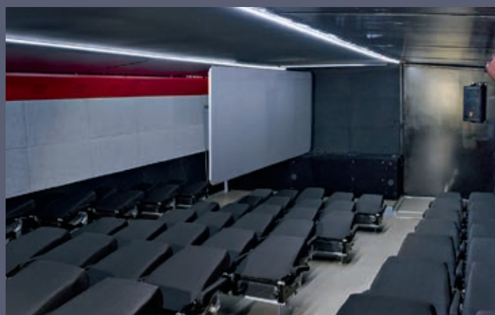
Перед переводом в транспортное положение экран устанавливается вдоль кузова, а спинки кресел складываются
