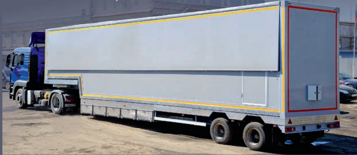
Хитроумная система сегментированного складывания пола позволяет перевести кинотеатр в транспортный режим за несколько минут
