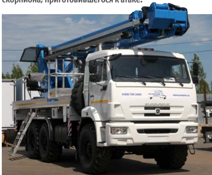
Большая редкость, когда огромная 35-метровая вышка в транспортном положении не выдаётся за пределы базового шасси
