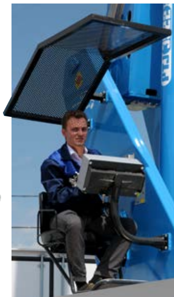
Место оператора гидроподъёмника защищено стальным каркасом с прочной сеткой от случайного падения предметов сверху
