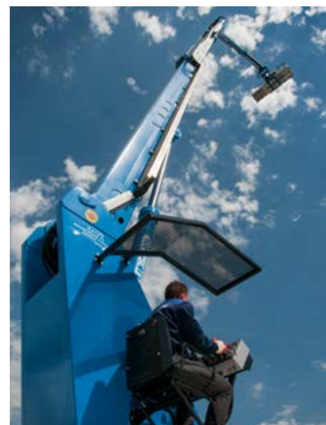
При работе на малых высотах оператор может управлять гидроподъёмником ISOLI PTJ 35.22 SL с нижнего пульта, а на больших высотах удобнее воспользоваться управлением из корзины
