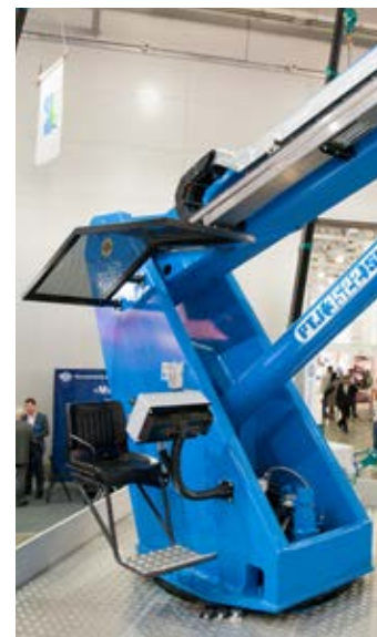
Опорная колонна гидроподъёмника, как и стрела, выполнены из высокопрочной конструкционной стали, выдерживающей предельные нагрузки
