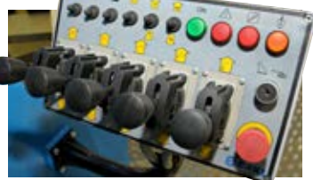
Управление гидроподъёмником сделано буквально на интуитивном уровне: в рычагах, кнопках и тумблерах помогают разобраться соответствующие изображения
