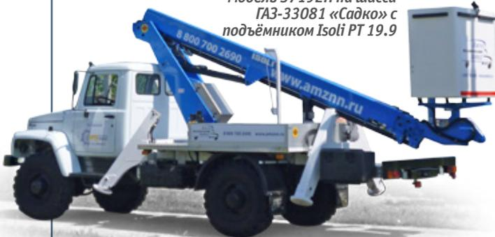
В результате на обычное шасси ГАЗ-33081 «Садко» с минским дизелем была водружена на-стройка Isoli PT 19.9. Подъёмник имеет довольно привычную схему – опорная колонна, основная стрела и две телескопические секции. Рабочий угол охватывает диапазон от отрицательных –24° до 80°. Люлька тоже стандартная стеклопластиковая, габаритные размеры 1400x700x1100 мм. Стоит отметить возможность разворота корзины относительно стрелы на 90°.
